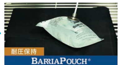
バリアパウチでは水漏れは発生しませんでした。
